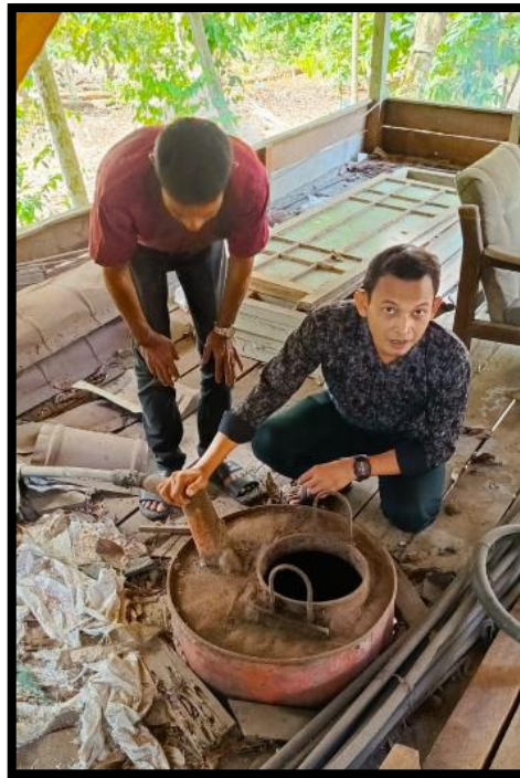
Gambar 4. Kondisi Karat tebal pada ketel
