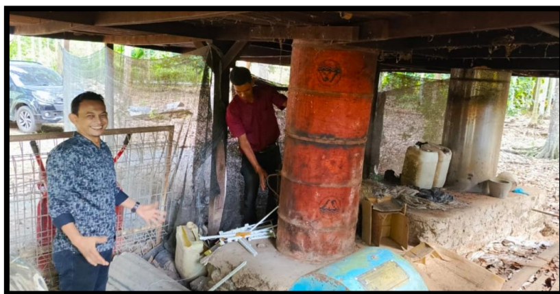
Gambar 2. Kondisi umum ketel distilasi nilam
